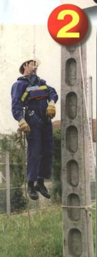
**Derope je evakuační a záchranné zařízení pro okamžité použití. Tento kompaktní a lehký automatický spouštěč pracuje systémem tam a zpět na semi-statickém laně 9 mm.**
